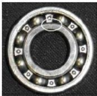
شکل (۵): ترک روی سطح تماس حلقه داخل یک یاتاقان
